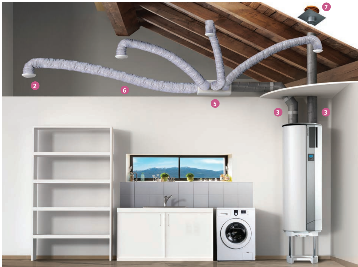
Réseau pieuvre en volume non chauffé (le réseau d'extraction doit impérativement être isolé thermiquement)
